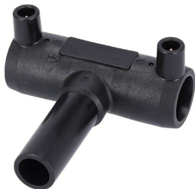
DIE ELEKTROSCHWEISSFITTINGS SIND AUS POLYETHYLEN PE100-RC IM SPRITZGUSSVERFAHREN HERGESTELLT, WERDEN MIT EINER SICHERHEITSSPANNUNG VON  $\leq 48$  V BETRIEBEN UND SIND MIT EINEM SCHWEISS- UND RÜCKVERFOLGBARKEITS-STRICHCODE VERSEHEN. SIE EIGNEN SICH FÜR ROHRLEITUNGEN FÜR DIE VERTEILUNG VON GAS, WASSER UND FLÜSSIGKEITEN UNTER DRUCK, MIT EIGENSCHAFTEN IN ÜBEREINSTIMMUNG MIT DEN NORMEN EN 12201-3 (WASSER), EN 1555-3 (GAS), EN ISO (FLÜSSIGKEITEN FÜR INDUSTRIELLE ANWENDUNGEN).
