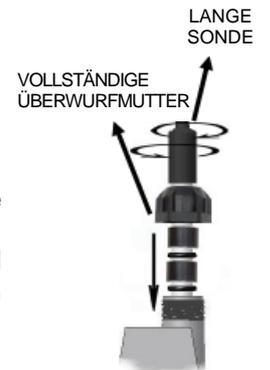
**Achtung**, biegen Sie die Elektrode nie um, da sie sonst unwiederbringlich beschädigt werden würde. Der Innenteil der Elektrode ist sehr zerbrechlich.
