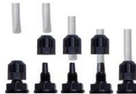
**Installation einer langen Elektrode (120 mm)**
