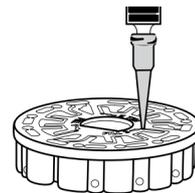
1. FÜLLEN SIE DIE SCHEIBE MIT LANGSAMEM, GLEICHMÄSSIGEM DRUCK. DAS PROBENWASSER FÜLLT DIE ZWISCHENRÄUME ZWISCHEN DEN ABLENKPLATTEN ENTGEGEN DEM UHRZEIGERSINN. JEDER RAUM WIRD VON UNTEN NACH OBEN GEFÜLLT. FÜLLEN SIE DAS PROBENWASSER SO LANGE EIN, BIS DAS PROBENWASSER IN DER VIERTEN KAMMER BIS ZUM OBEREN RAND DER KAMMER KNAPP ÜBER DIE EINGEPRÄGTE FÜLLLINIE HINAUS REICHT. ES IST IN ORDNUNG, ETWAS ÜBER DIE FÜLLLINIE HINAUS ZU FÜLLEN.
