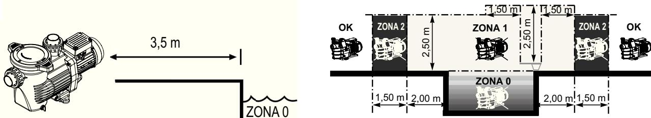
Installare la pompa in un locale ventilato e asciutto, poiché il motore richiede che l'aria circoli liberamente attorno ad essa, per consentirne la ventilazione naturale. Verificare regolarmente che il dispositivo di raffreddamento del motore non sia ostruito da oggetti, foglie o altri ingombri.
