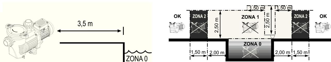
Instalar la bomba en un local ventilado y seco, el motor exige que el aire circule libremente alrededor de la bomba para que se ventile naturalmente. Comprobar regularmente que no haya objetos, hojas o cualquier otro obstáculo que pudiese obstruir la refrigeración del motor.
