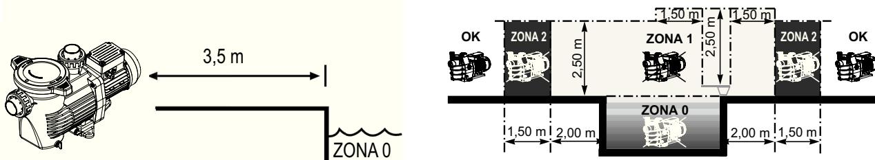
Instalar a bomba num local ventilado e seco; o motor precisa que o ar circule livremente à volta da bomba para permitir a sua ventilação natural. Verificar regularmente que objectos, folhas ou quaisquer outros elementos não obstruem a refrigeração do motor.
