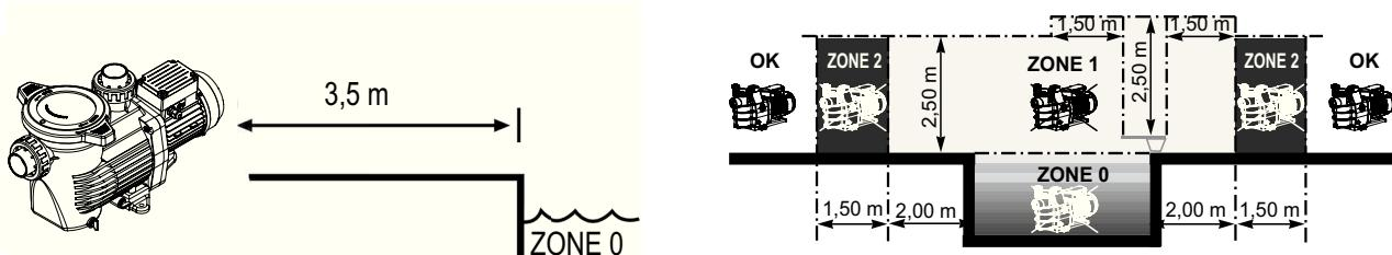
De pomp in een verluchte en droge ruimte installeren, de lucht moet vrijelijk rond de motor kunnen circuleren zodat hij op natuurlijke wijze verlucht kan worden. Regelmatig controleren of de motorkoeling niet verhindert wordt door voorwerpen, bladeren of andere obstakels.
