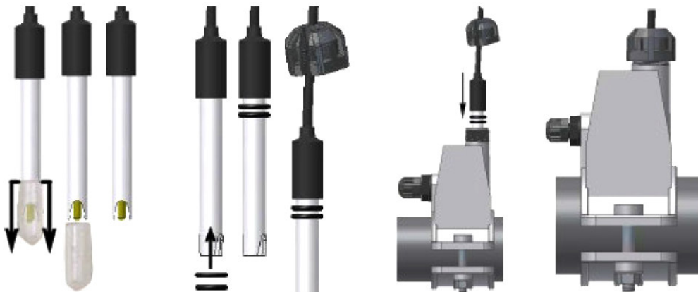
Abb. 3 - Montage der Sonde im Sondenhalter
