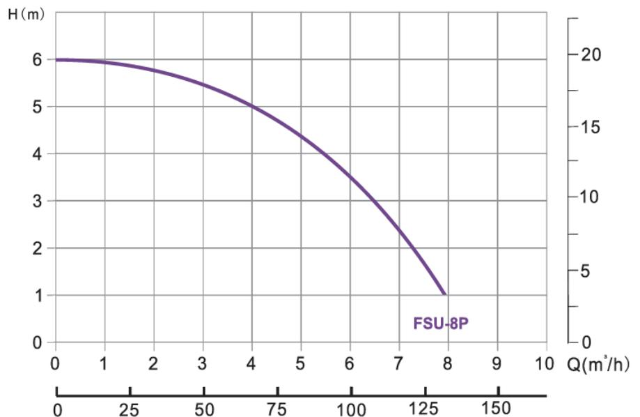
HINWEIS: DIE ANGABEN ZUR DURCHFLUSSKURVE BASIEREN AUF EINEM 220V/50Hz MOTOR.
