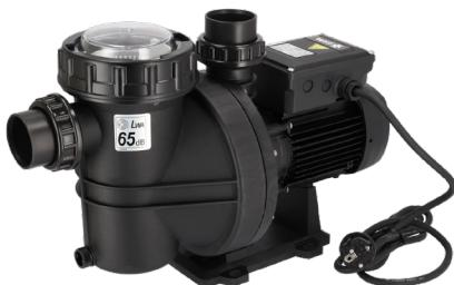
Die Schwimmbadpumpe ESPA „NOX“ ist eine einstufige Kreiselpumpe zur Umwälzung und Filtration von Wasser. Die Pumpe ist geeignet für Wasserrumwälzung und -filtration in kleinen und mittelgrossen privaten Schwimmbecken. Die Kreiselpumpe ist mit einem langlebigen Gleitdichtring ausgestattet. Die ESPA „NOX“ bietet eine optimale Geräuschoptimierung sowie Effizienz. Die Schwimmbadpumpe ist selbstansaugend bis zu 4 m.
